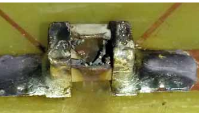
Fot. 1. Bezpiecznik SMD, który nie wyłączył prądu prawidłowo
